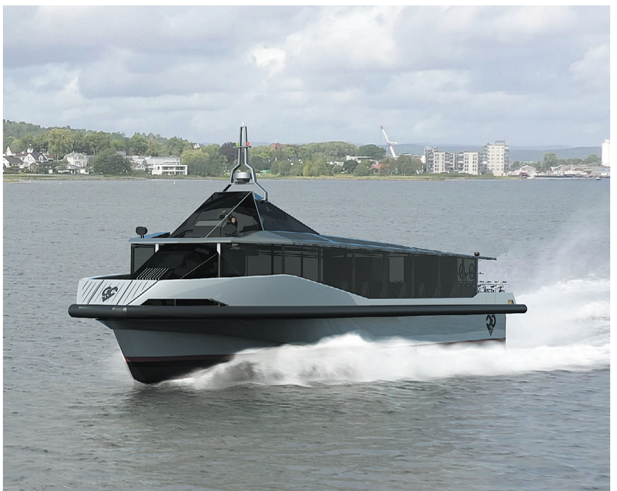
Green City Ferries eldrivna passagerarfartyg får sin energi från ett batterisystem med som kan snabbladdas på cirka tio minuter.
